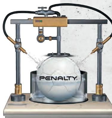
A BOLA É PESADA E COLOCADA DENTRO DE UM RECIPIENTE COM ÁGUA E COMPRIMIDA 250 VEZES. DEPOIS DISSO, ELA É PESADA NOVAMENTE, PODENDO VARIAR NO MÁXIMO EM 10%.
