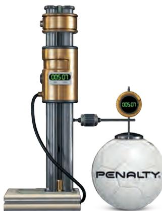
A BOLA É MEDIDA EM 10 PONTOS DIFERENTES QUE INDICAM O DIÂMETRO, QUE DEVE TER O MÍNIMO DE VARIAÇÃO ENTRE OS PONTOS, ONDE SERÁ CALCULADO EM CIMA DA MÉDIA A CIRCUNFERÊNCIA EM CENTÍMETROS. A VARIAÇÃO ENTRE O MENOR E MAIOR PONTO INDICARÁ A ESFERICIDADE, QUE NÃO DEVE EXCEDER 1,5%.
